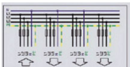
Komplettes fünfpoliges elektrisches Netz (TN-S).
